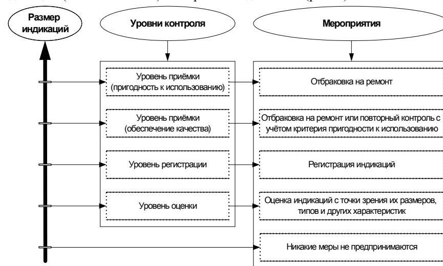
Рисунок 2 Классификация индикаций дефектов сварных соединений
